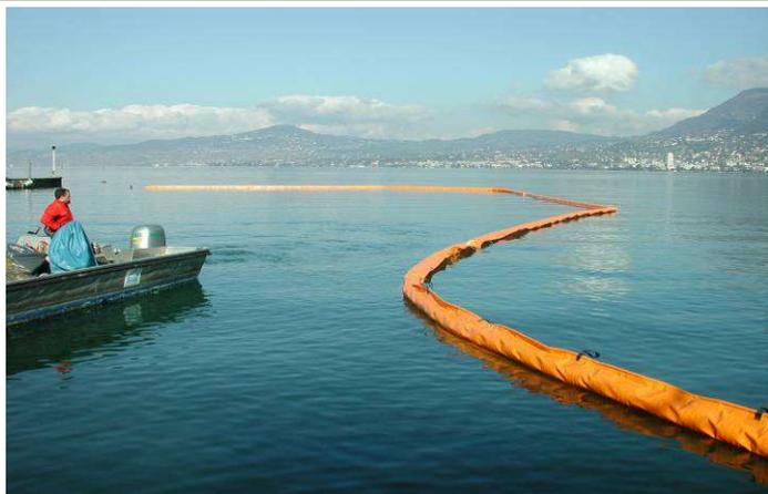
Le barrage type LEMAN B est destiné à la lutte contre la macro-pollution. Ce barrage a été mis au point pour le confinement des nappes de déchets de bois sur les lacs et divers plans d'eau.
