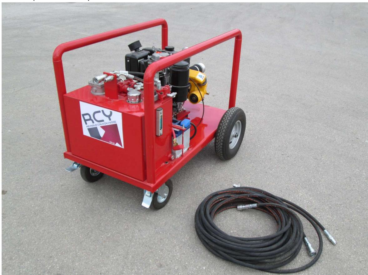
C'est une pompe à auto-amorçage à double diaphragme, d'une capacité maximum de 30 m<sup>3</sup>/h équipée de manchons 2.5 pouces camlock d'admission et de refoulement. Elle peut traiter des solides à dimension allant jusqu'à 6mm, tous les joints sont construits de caoutchouc synthétique pour la protection contre toutes les huiles rencontrées. Elle est montée sur un châssis portatif en acier dur sur 2 roues, avec poignée pliante permettant un déploiement facile.
